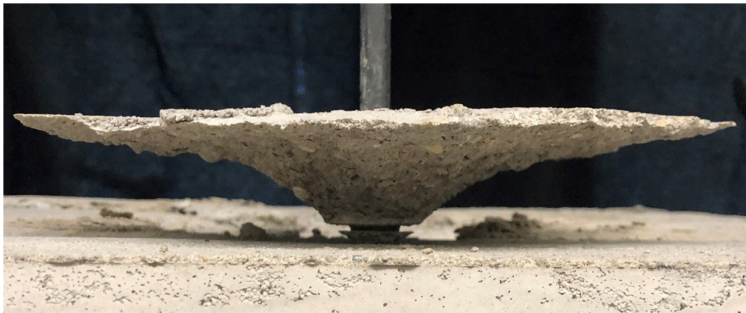
Ausbruchkegel eines Versuchskörpers ohne Polypropylenfasern
