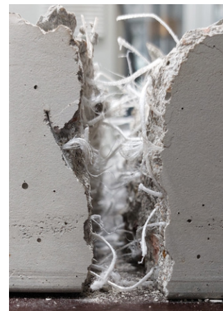
Rissufer der mit Polypropylen-Makrofasern bewehrten Kreisplatte
