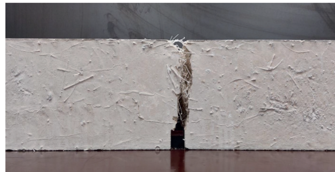
Riss eines Versuchskörpers mit Makropolymerfasern
