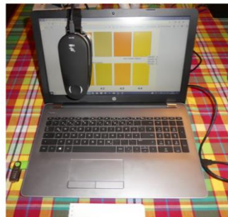
Abb. 4: Photographie eines mobilen und zertifizierten Farbmessgerätes i1Pro Rev E von Fa. x-rite, bestehend aus einem Messkopf, einem Notebook mit der Auswertesoftware SpectraShop 5 /29/, im Emissionsbetrieb (links) und Reflexionsbetrieb (rechts)
