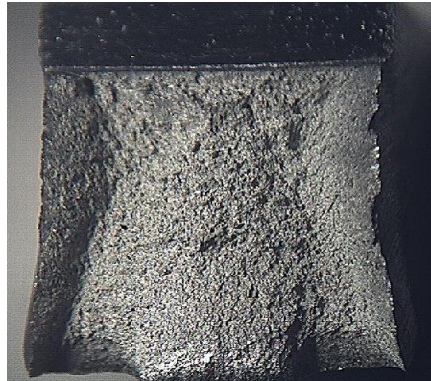
Bruchfläche einer Kerbschlagbiegeprobe
