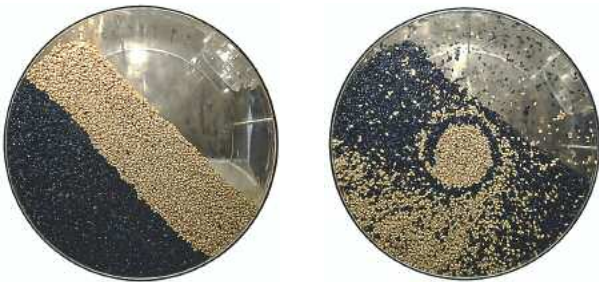
Radiales Mischverhalten in einer rotierenden Trommel. Links: Material zu Versuchsbeginn. Rechts: Mischung nach 5 Umdrehungen.
